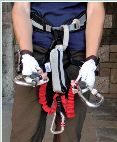
Dissipador d'energia en forma de Y
