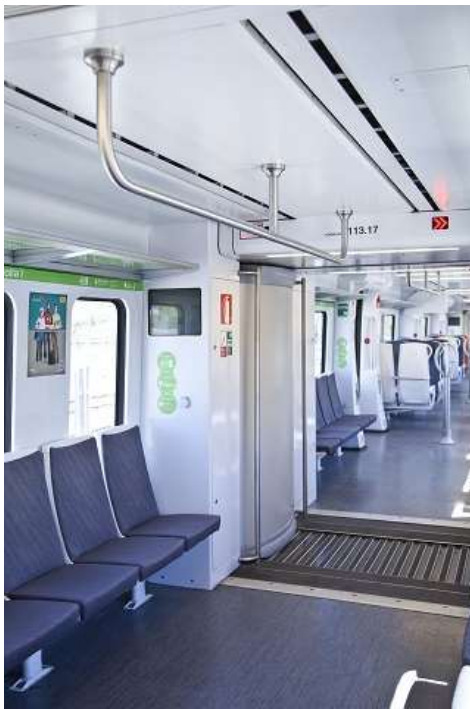
Imatges de l'antic disseny dels agafadors i del sistema actual.
