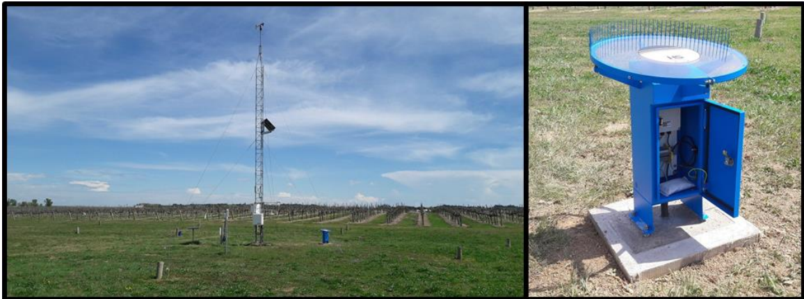
Figura 2. Esquerra: Pla general de l'estació meteorològica automàtica de Raimat. Dreta: Granímetre automàtic.
