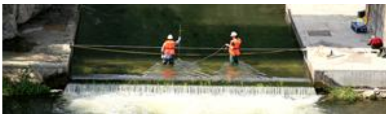
Aforadors mesurant el cabal d'aigua d'un tram de riu.
