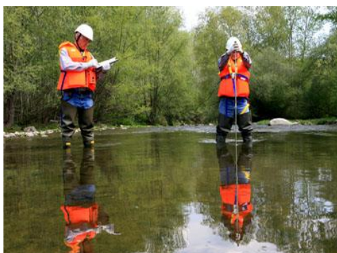
Tècnics aforadors mesurant el cabal d'un riu.
