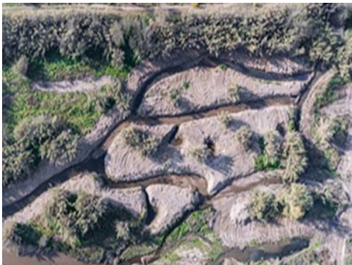
Riera de Vallmanya (Tordera), on s'han excavat sediments a la llera i s'han revegetat els talussos.
