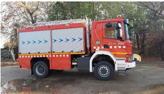
Model SCANIA P320 B4X4 240 CV Canvi marxes automàtic Cisterna aigua 500 L
