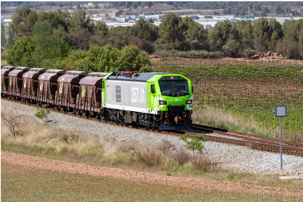
Un tren de potassa d'FGC, amb una de les noves locomotores duals
